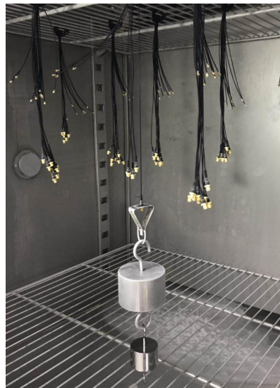
砝码吊重+低温实验
